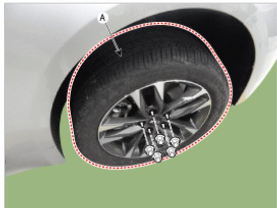
拆卸车轮和轮胎 (A) 时注意不要损坏车轮螺母。
